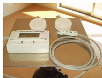
パッシブ方式による空気採取状況
