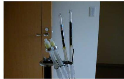
アクティブ方式による空気採取状況
